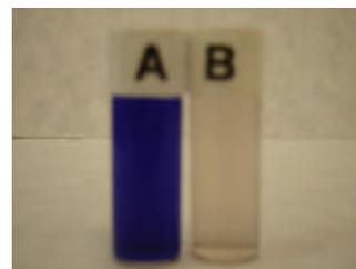
**Figura 3.** Solução do corante antes (A) e após tratamento (B) com 1% (m/v) de farelo de soja a temperatura de 50 °C.
