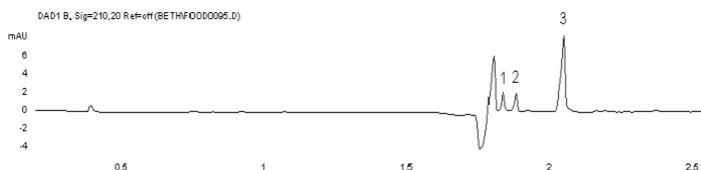
Figura 3. Eletroferograma da amostra de salsicha contendo 20 mg/L de sulfito (PI) . Picos: 1.Nitrito, 2.Nitrato, 3. Sulfito. Condições de separação como descrito na Figura 1.
