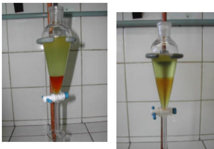
**Figura 1:** Processo de separação do biodiesel via as rotas metílica e etílica, respectivamente.
