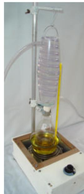
Figura 2: Montagem da aparelhagem.
