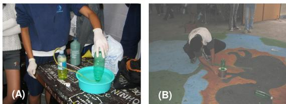
Figura 1: Produção e recolhimento de H<sub>2</sub> (A); combustão do H<sub>2</sub> (B).
