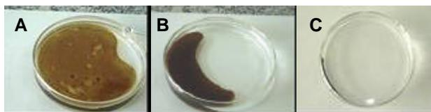
Figura 1. Encolhimento da mancha de petróleo cru da bacia de Campos. (A) Adição da composição, (B) Após 2 segundos; (C) Após 4 minutos.
