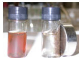
Figura 2 Fotografia da suspensão de Fe<sub>3</sub>O<sub>4</sub>/Ag na ausência e na presença de um campo magnético externo
