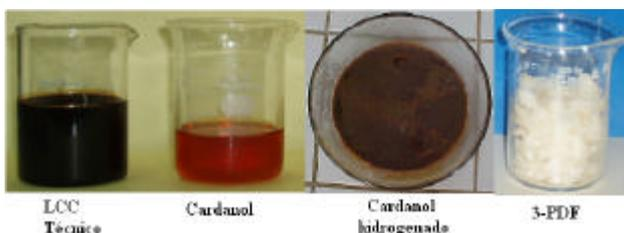
Figura 1. Variação de coloração de acordo com as etapas do processo de obtenção do 3-PDF
