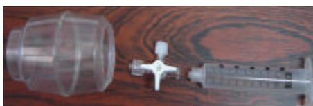
Figura 1. Material para a montagem do “Kit” de baixo custo para experimento de titulação ácido base.
