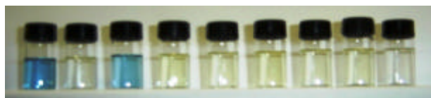
Figura 3. Coloração das soluções (esquerda para direita): MB, MBH, MBH+ \text{F}^- , MBH+ \text{Cl}^- , MBH+ \text{Br}^- , MBH+ \text{I}^- , MBH+ \text{NO}_3^- , MBH+ \text{H}_2\text{PO}_4^- e MBH+ \text{HSO}_4^- .
