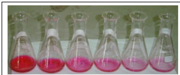
Figura 3- Redução da coloração do efluente - Efluente bruto, uma hora, duas, três, quatro e cinco horas de tratamento, respectivamente.
