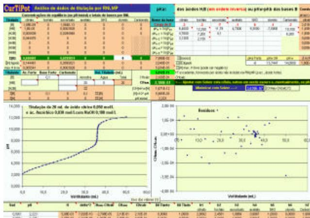
Figura 1. Módulo de análise por RNLMP com auxílio da macro Solver do Excel®
