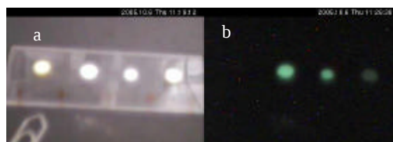
Figura 1. Fotos do comportamento das pastilhas de Gd_2O_2S sob excitação de raios X. (a) Pastilhas sem excitação por raios X. (b) Pastilhas irradiadas com feixe de raios X de 140kV/25mA.
