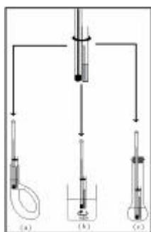
**Figura 1:** Dispositivos de aquecimento (a) tubo de thiele; (b) béquer; (c) balão.
