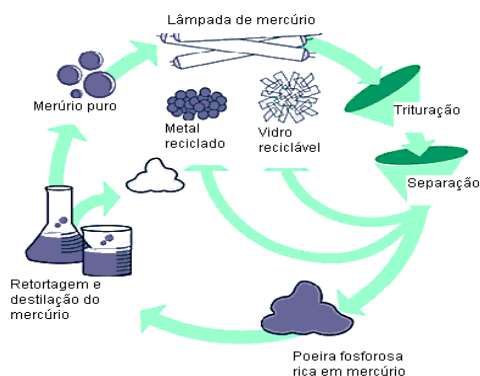
Figura 6. Processo de reciclagem de lâmpadas fluorescentes [25].
