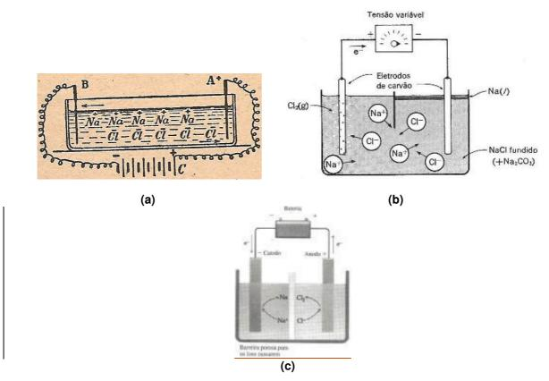
Figura 2. Representações para o fenômeno de eletrólise disponíveis em obras didáticas ao longo do século XX: (a) Eletrólise do NaCl (Puig, 1932); (b) Eletrólise do NaCl (Pimentel e Spratley, 1974); (c) Eletrólise do NaCl (Kotz, 1998).
