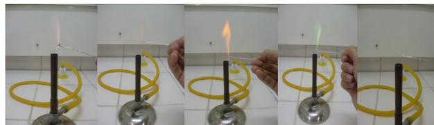
Figura III: Ensaio de chamas realizado com materiais alternativos (da esquerda para a direita: A, B, C, D e E).
