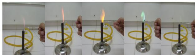
Figura II: Ensaio de chamas realizado com sais de laboratório (da esquerda para a direita: K, Ca, Na, Cu e B).
