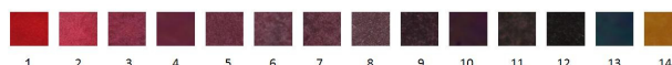
Figura 2. Escala de cores para pH do papel indicador com extrato de ACYS de jussara
