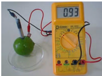
FIGURA 4. Pilha de zinco e cobre com limão
