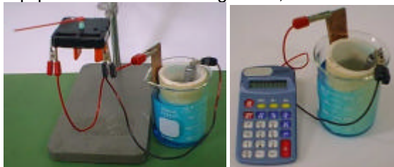
FIGURAS 9 E 10: Funcionamento do relógio e da calculadora
