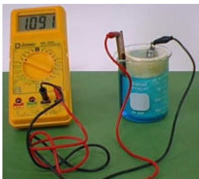
FIGURA 8. Pilha de zinco e cobre com membrana porosa.
