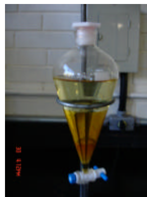
Figura 7: biodiesel e glicerina separados por fases (biodiesel - fase superior, glicerina - fase inferior).
