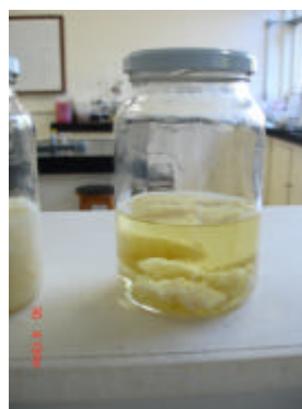
Figura 9: Reação que saponificou devido à grande umidade presente no óleo.
