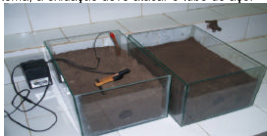
Figura. Conjuntos com tubulações enterradas; um deles com o sistema de proteção catódica por corrente impressa.
