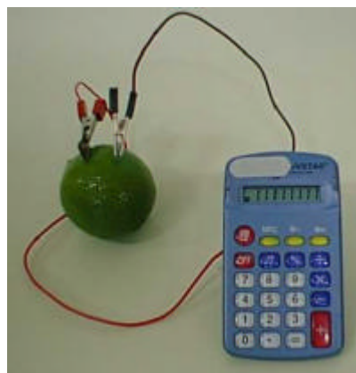
FIGURA 5 – Calculadora movida pela pilha de magnésio e cobre com limão.
