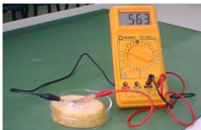
FIGURA 2. Pilha de alumínio e cobre com batata
