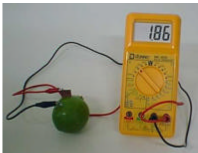
FIGURA 3. Pilha de magnésio e cobre com limão
