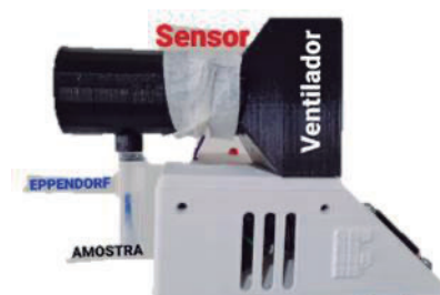
Figura 1. Nariz Eletrônico (e-nose) lab-made para determinação do teor de etanol em álcool sanitizante.
