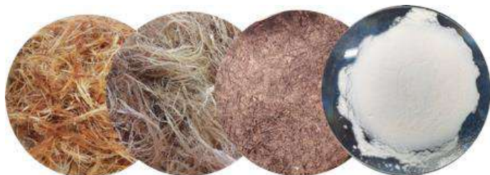
Figura 1. Aspecto visual (da esquerda para a direita) da fibra de coco a cada etapa dos tratamentos químicos
