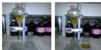
Figura 1 - Separação de fases por TDSP e por catálise homogênea básica respectivamente.
