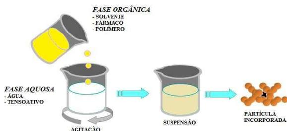
**Figura 1.** Representação esquemática do método nanoprecipitação
