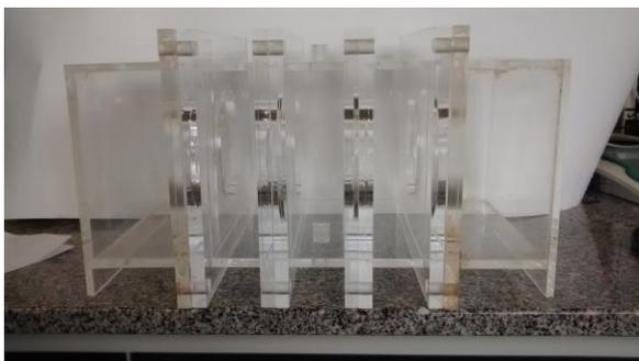
**Figura 1.** Célula de eletrodialise com cinco compartimentos utilizada nos experimentos.
