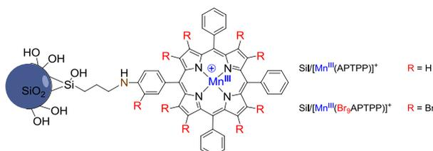
Figura 1. Representação da imobilização das MnPs à sílica-gel funcionalizada (Sil-Cl).
