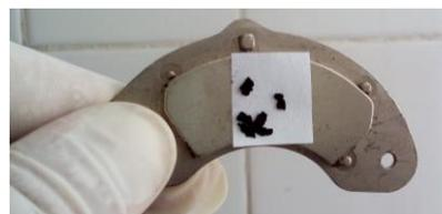
**Figura 3.** Foto da compósito próximo a um imã
