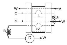
**Figura 1.** Diagrama do sistema de análises em fluxo empregado para determinação da seletividade relativa da resina catiônica. A: amostra; L: alça de amostragem (125 μL); col: coluna de acrílico preenchida com AG 50W-X8; B<sub>1</sub> e B<sub>2</sub>: reatores helicoidais 150 e 70 cm, respectivamente; C: solução carregadora (1,6 mL min<sup>-1</sup>), H<sub>2</sub>O; S: solução de regeneração da resina, NaCl 1x10<sup>-5</sup> mol L<sup>-1</sup>); D: detector e W: descarte.
