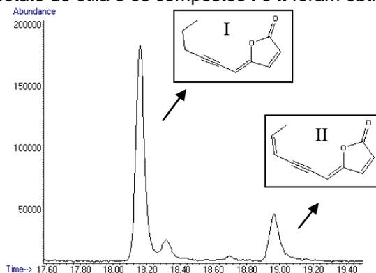
**Figura 1.** Cromatograma GC-MS do extrato obtido por PHWE. Coluna: Agilent HP-5 (30 m x 250 µm x 0,25 µm). Rampa: 90-150 (3°C.min<sup>-1</sup>) e 150-280 (20 °C.min<sup>-1</sup>). Concentração: 1,0 mg.mL<sup>-1</sup>. Split 1:100.
