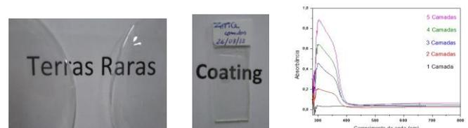
**Figura 4.** Imagens dos filmes finos produzidos e espectros de absorção no UV-Vis para cada camada de filme depositada no vidro.
