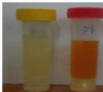
Após, a formação as emulsões foram levadas a um banho com aquecimento (80°C), a amostra contendo 0% de ácido não quebrou, 5%- 15 min (coloração amarelo\ opaco), 10% - 15 min (coloração amarelo\ opaco), 15% - 40 min (coloração amarela\ opaco), 30% - 10 minutos (coloração laranja\ opaco) e 50% - 5 min ( laranja\ incolor).
