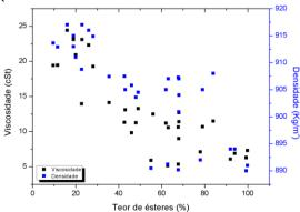
**Figura 2.** Relação da densidade e viscosidade em função do teor de TAG.
